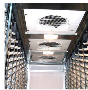
Incubadora Classic con tableros ventiladores plásticos Vostermans en posiciones de funcionamiento y de mantenimiento
