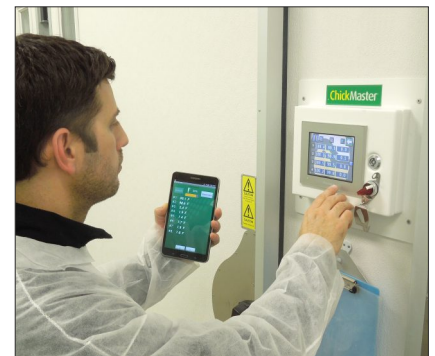
Un dispositivo móvil Android recibe los valores actuales de temperatura y permite al técnico hacer ajustes en la pantalla de control
