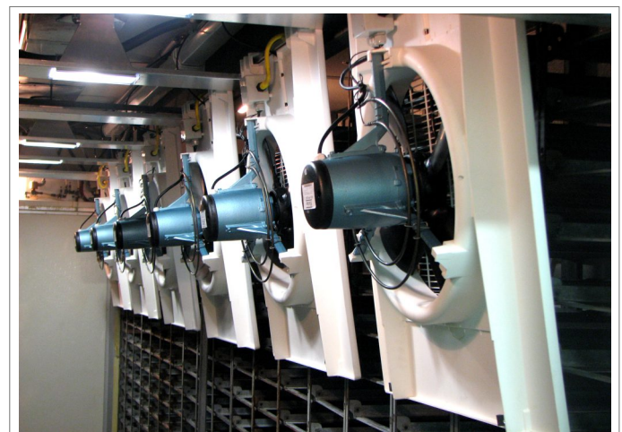
Resistencia de calefacción y sistema de humedad Cyclomist montados en el ensamble del tablero plástico de ventiladores
